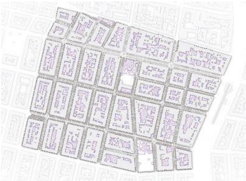
In dem dicht bebauten Testgebiet in 1160 Wien wurde über GIS-Analysen ermittelt, wo Bohrungen für Erdwärmesonden platziert werden könnten. Die Punkte zeigen mögliche Orte für Bohrungen. Rund 60% der Erdwärme-Speicherkapazität liegt dabei auf öffentlichen Flächen, 40% auf privatem Grund wie z.B. in Innenhöfen. Quelle: TU Wien
