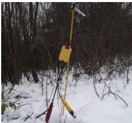
Geophone - eines von 30 000 elektronischen Ohren in Klosterneuburg
