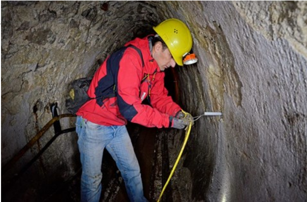
Die Messkabel werden an den Elektroden befestigt. Foto: Daniel Brandner
