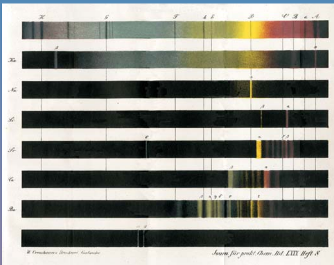
Abb. 3: Tafel mit den Spektren der Alkali- und Erdalkalimetalle im Vergleich mit dem Sonnenspektrum sowie zu unterst das von Cäsium (aus [3])
