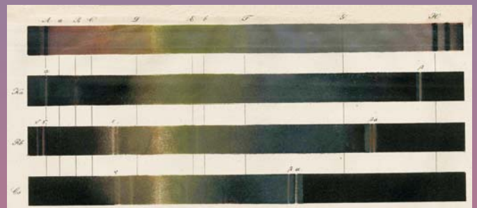
Abb. 4: Die Spektren von Cäsium und Rubidium im Vergleich mit dem Sonnen- und Kaliumspektrum (aus [5])
